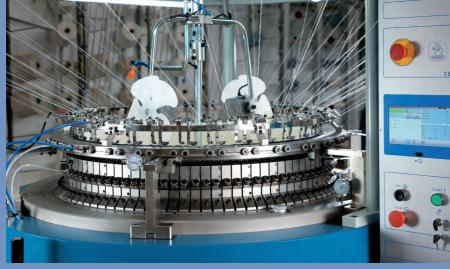
Tradizionale basamento Orizio modulare, rinnovato nella funzionalità, robustezza ed estetica con nuovo pannello di controllo "Oritec" che permette la fruizione di nuove tecnologie ed ingloba in un'unica scheda elettronica le sequenti funzioni:
