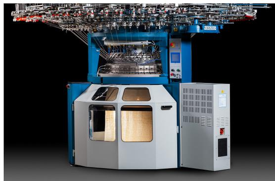
Tradizionale basamento Orizio modulare, rinnovato nella funzionalità, robustezza ed estetica, con un nuovo pannello di controllo 'ORITEC' che permette la fruizione di nuove tecnologie e ingloba in un'unica cabina elettrica le seguenti funzioni:
